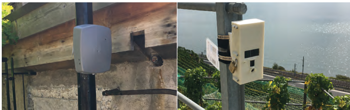
Figure 6 – Un compteur de type Pyro (à gauche) et une caméra (à droite).
